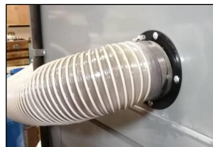
Фигура 3 - Връзка между прахосмукачка и пясъкоструйка.
