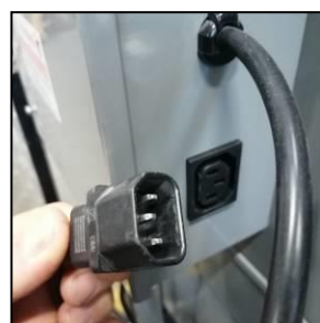
Фигура 4 - Свързване на захранването на прахосмукачката.
